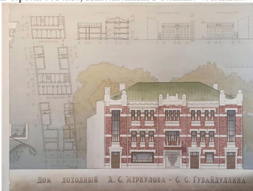
Рис. 9. Чертеж в технике «отмывка» «Доходный дом А.С. Меркулова-С.С. Губайдуллина»
