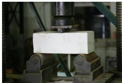
Испытание силикатного кирпича на изгиб
