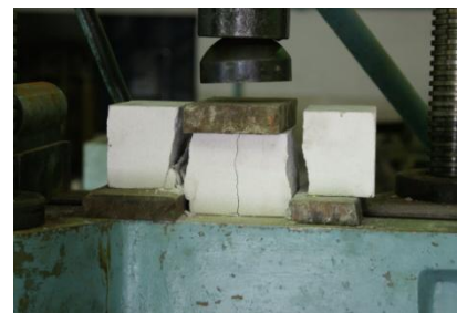
Испытание силикатного кирпича на срез
