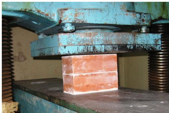
Образец из пустотных керамических кирпичей
