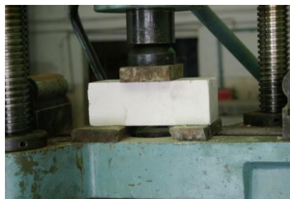
Испытание силикатного кирпича на срез
