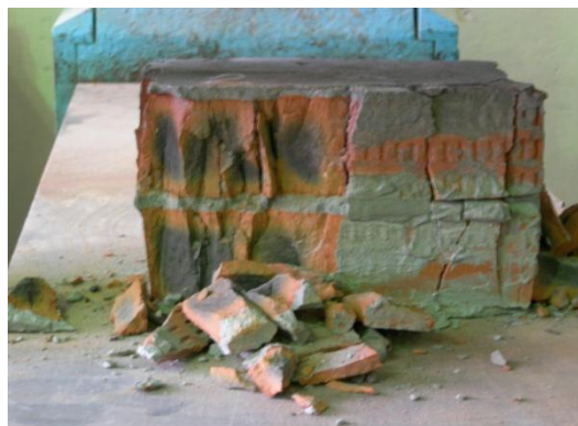
Испытанный образец из полнотелых керамических кирпичей
