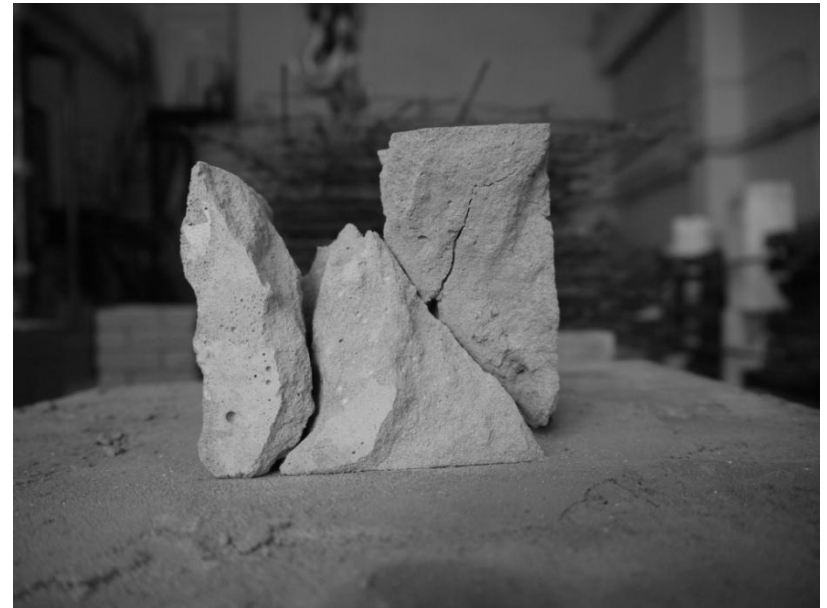
Характер разрушения опытного образца
