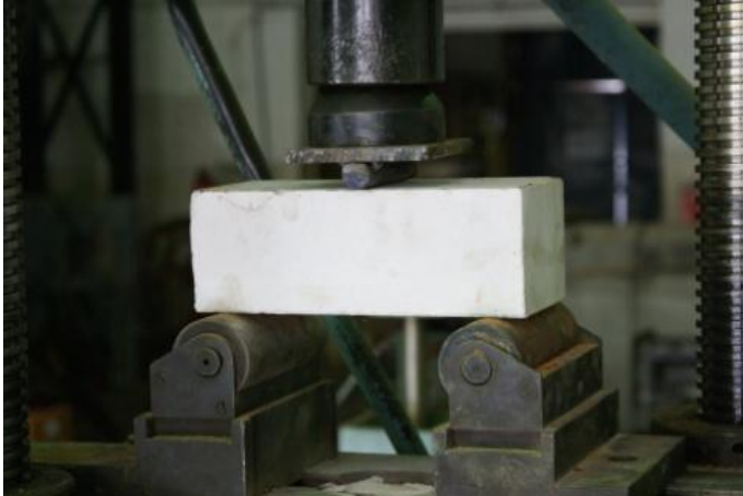
Испытание силикатного кирпича на изгиб
