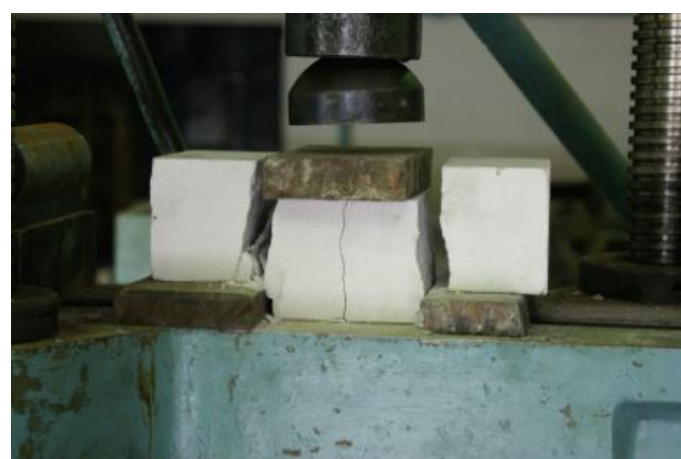
Испытание силикатного кирпича на срез
