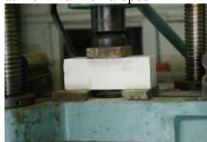
а. Испытание на срез
