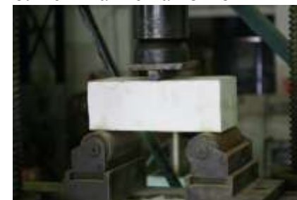
б. Испытание на изгиб
