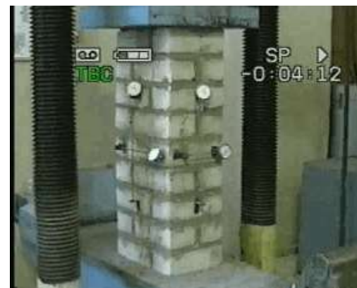
Рис. 11. Подготовленный к испытанию каменный столб
