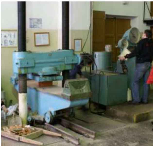
Рис. 2. Проведение испытания керамического кирпича на прессе ИПС-200
