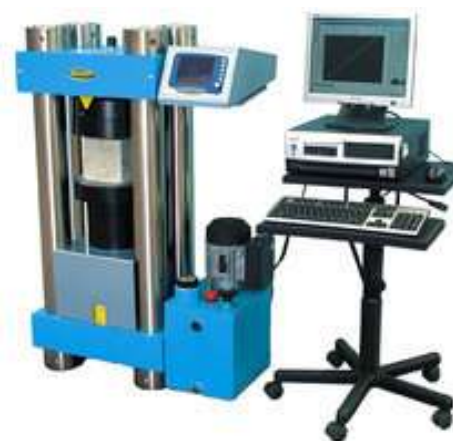
Рис. 1. Испытательный пресс для определения прочностных характеристик материалов
