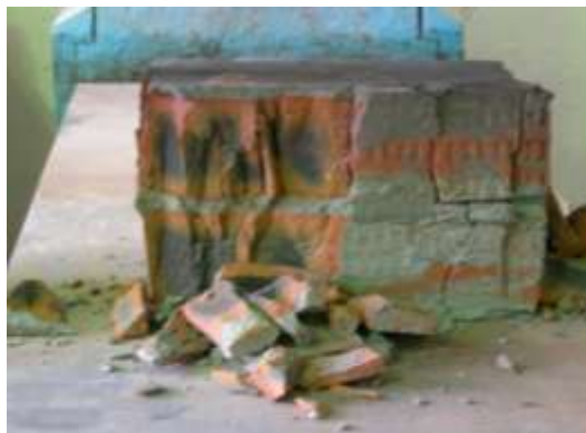
Рис. 7. Испытанный образец из керамического полнотелого кирпича
